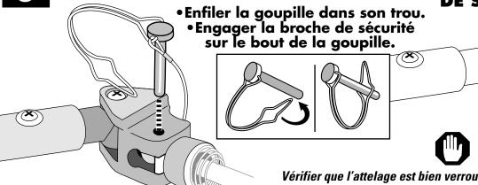
Vérifier que l'attelage est bien verrouillé en place en tirant et en tournant le timon: s'il se décroche, recommencer l'opération.
