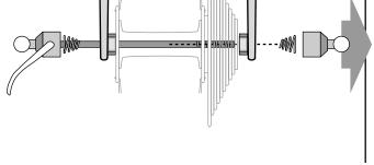
• Visser l'écrou sur l'axe en placant les rainures
