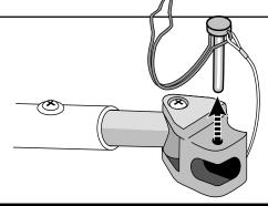
ATTACH HITCH TO THE SIDE OF THE BIKE WITHOUT THE DRIVE-TRAIN (GEARS).
