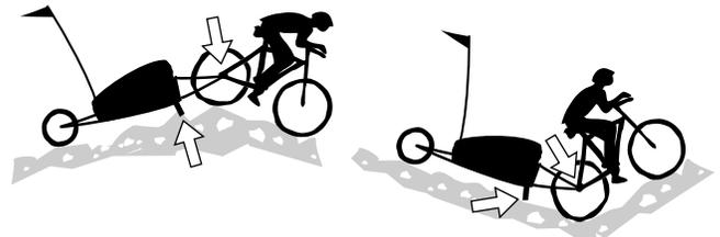
Les surcharges imposées par des pivotements de trop grande amplitude peuvent détériorer les points de fixation de la remorque et son comportement, et endommager le vélo, la remorque ou provoquer la chute du cycliste imprudent.
