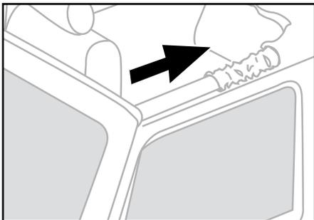
Empuje hacia atrás el acolchado de la cubierta plegable para armazón.
