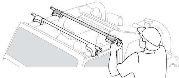
Distance maximale entre les barres transversales = 71 cm (28 po)
