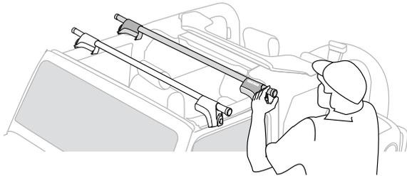
Separación máx. entre las barras transversales = 28 in / 71,12 cm
