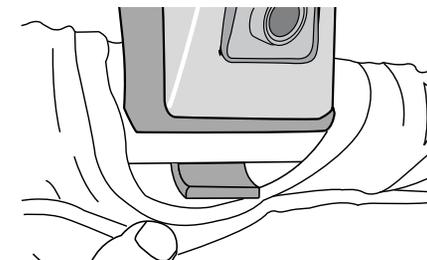
Placer la mâchoire sur l'arceau de sécurité au niveau de l'interruption de la mousse.
