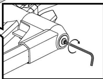
Il faudra peut-être régler à l'occasion la tension des bras pivotant. Utiliser une clé hexagonale de 5 mm.
